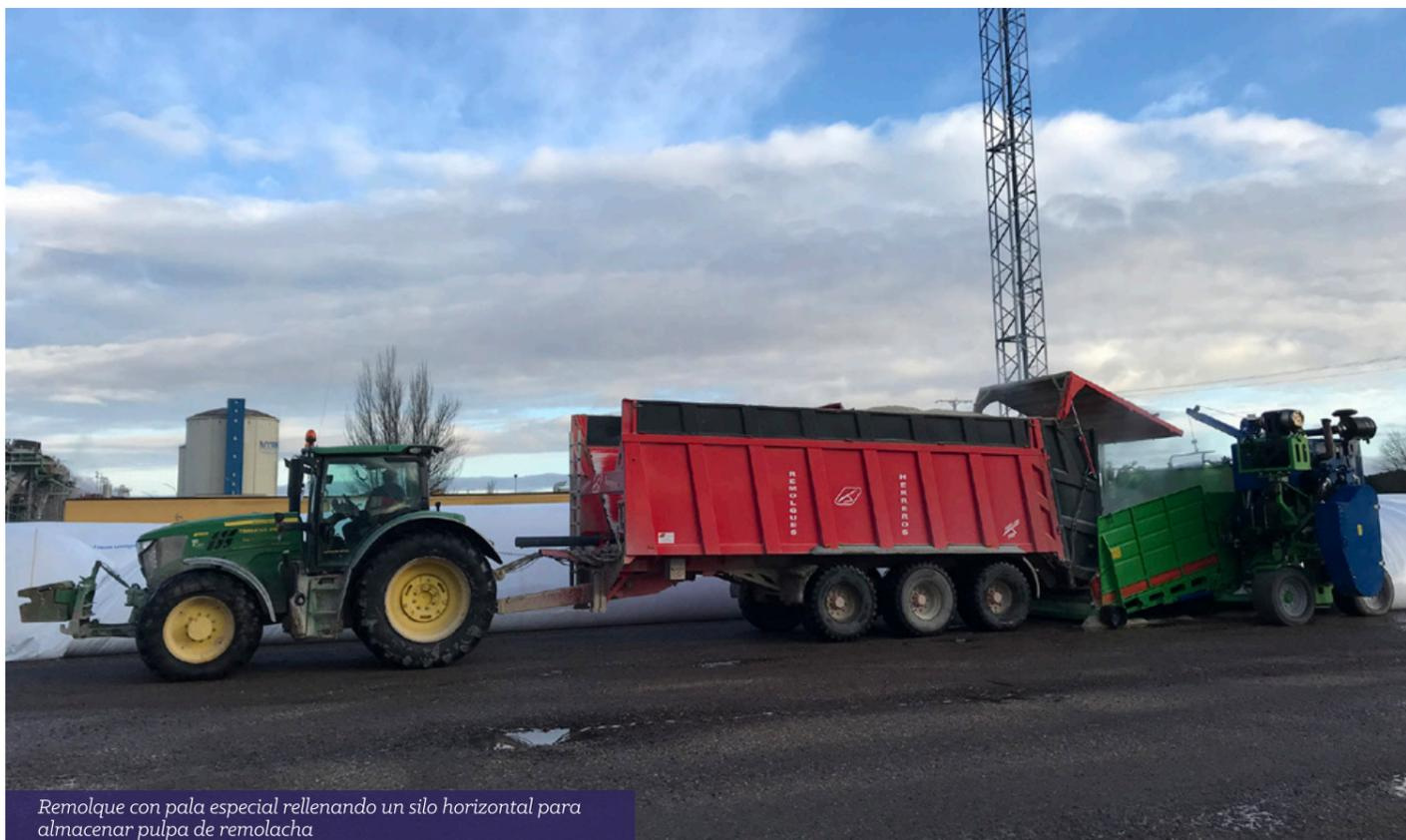
Remolque con pala especial relleno un silo horizontal para almacenar pulpa de remolacha
